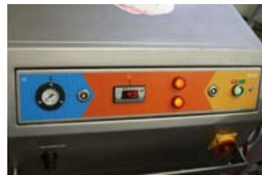
*Zum Aprikotieren und Glasieren der Gebäcke dienen der Aprikotier- und der Glasier Boy 200 von Boyens. Während der Aprikotier-Boy die Marmelade direkt aus dem Fass zieht, ist der Glasier Boy mit einem ca. 20 Liter fassenden Fondantbehälter im Inneren ausgestattet. Mit Hilfe des digitalen Displays sind die gewünschte Temperatur und der Druck einfach einzustellen.*
