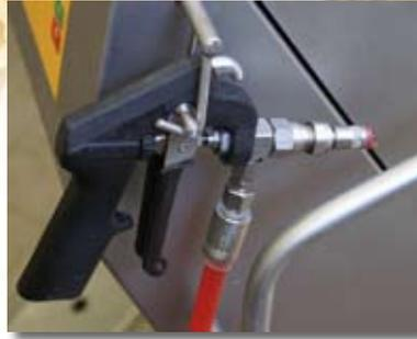
*Für gute Sprühergebnisse sorgen die gummiummantelte Sprühpistole sowie der beheizte Schlauch des Geräts.*
