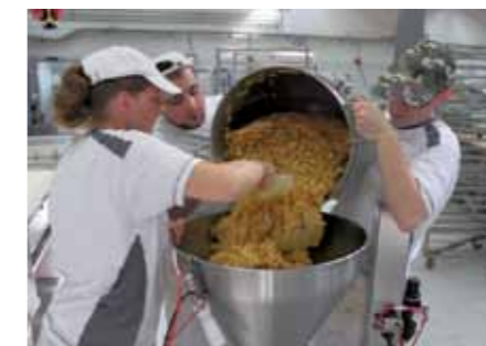
Das gleichmäßig runde Aufdressieren der Amerikanermasse erleichtert ein formgebender Lochtüllenauslass anstelle der zur Dosierung von Füllungen verwendeten Portionierdüse. Der Vorratstrichter der Maschine hat ein Fassungsvermögen von 52 l und kann zum Beispiel einen Kessel selbst hergestellter Apfelfüllung komplett aufnehmen. Bei der Herstellung des Plundergebäcks „Apfeltraum“ wird der tourierte Hefeteig zunächst computergesteuert ausgerollt und durchläuft dann den Schneidetisch.
