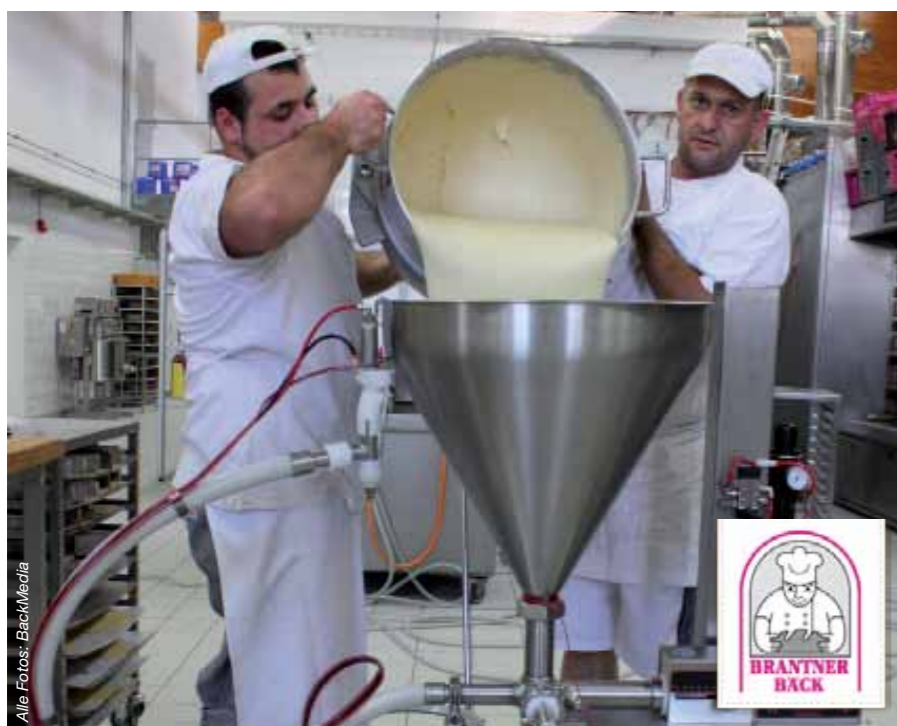
Der auf Rollen verfahrbare Unifiller Compact Powerlift 500 kommt sowohl in der Konditorei als auch in der Feingebäckabteilung am anderen Ende der Backstube zum Einsatz.
