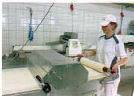
Das Aufdressieren der Amerikanermasse erleichtert ein formgebender Lochtüllenauslass. Auch Plundergebäck wird nach dem Ausrollen mit dem Unifiller gefüllt.
